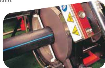
6. Mantenga los extremos de los tubos en contacto con la plancha de calentamiento durante el tiempo de calentamiento (T2). Ver Tabla #1
