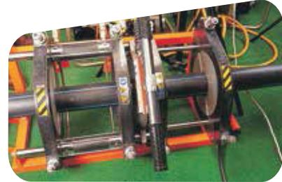
5. Mantenga la presión hasta que la Tubería se derrita uniformemente formando un reborde o cordón en el extremo con la altura que aparece en la Tabla #1 y mueva inmediatamente las válvulas de control a posición neutral para eliminar la presión de la Tubería contra la plancha de calentamiento.
