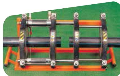
2. Determine la presión de arrastre (presión necesaria para acercar un extremo del tubo al otro).
