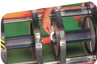
4. Tapone los extremos que no está soldando. Posicione la plancha de calentamiento y junte los extremos de los tubos aplicando la presión determinada antes.
